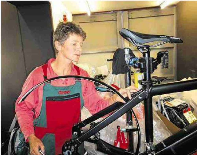
Rad weg, Schutzblech drauf: Regula Stricker baut diesen Stromer zur City-Version mit Gepäckträger und Velokorb um.
